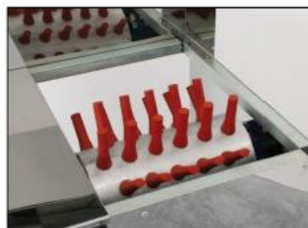
Hliníkový válec s větším průměrem a 54 prsty pro rychlejší a efektivnější škubání.
